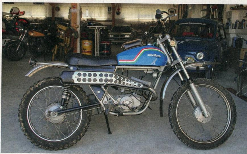
Aus Barzago stammt diese Fantic TX 96 Regularita. Der schlitzgesteuerte Sechsgangmotor leistet über sechs PS
